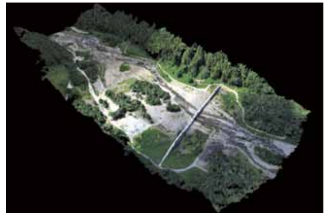
図4 ドローン測量システムで生成した点群データ
