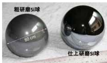
図3 アボガドロ数の測定を想定した単結晶シリコン球 （素材：新日本製鐵、研磨：芝浦工業大学、1995）
