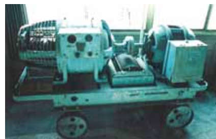
写真2 米GE社の直流溶接機 (右の交流モーターで左の直流発電機を回す)
