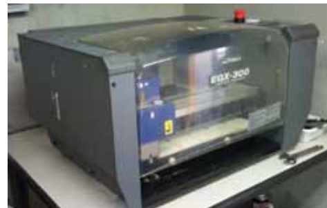
所持している機器の一つ CNC切削機 EGX-300
